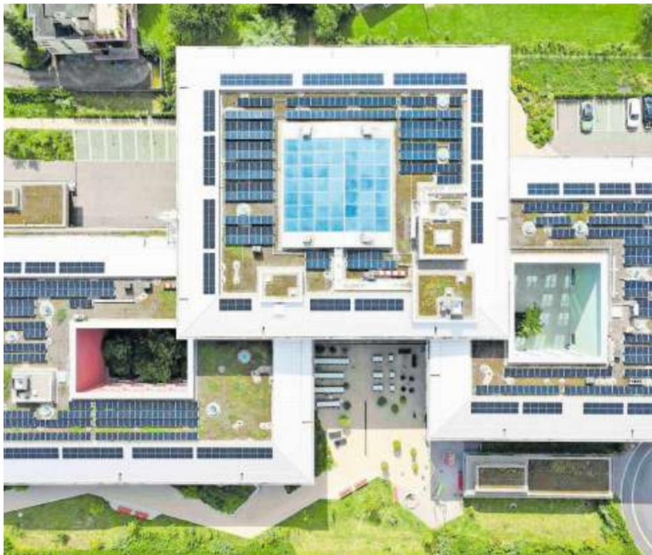
**Photovoltaikanlage** auf dem Dach des Alterszentrums St. Bernhard.
